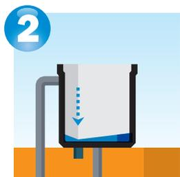
**2** Luego del lavado, vaciarlo completamente y enjuagar una o más veces, asegurando la eliminación de todo residuo visible. En lo posible, eliminar el agua por una salida independiente (purga de fondo) para evitar que pase por la cañería de distribución domiciliaria.
