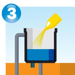
**3** Ingresar agua en el tanque hasta 20-30 cm. de altura y agregar agua lavandina concentrada (proporción: dos litros de agua lavandina por cada 500 litros de capacidad del tanque). Utilizar solamente agua lavandina que contenga en su composición hipoclorito de sodio (sin fragancias).
